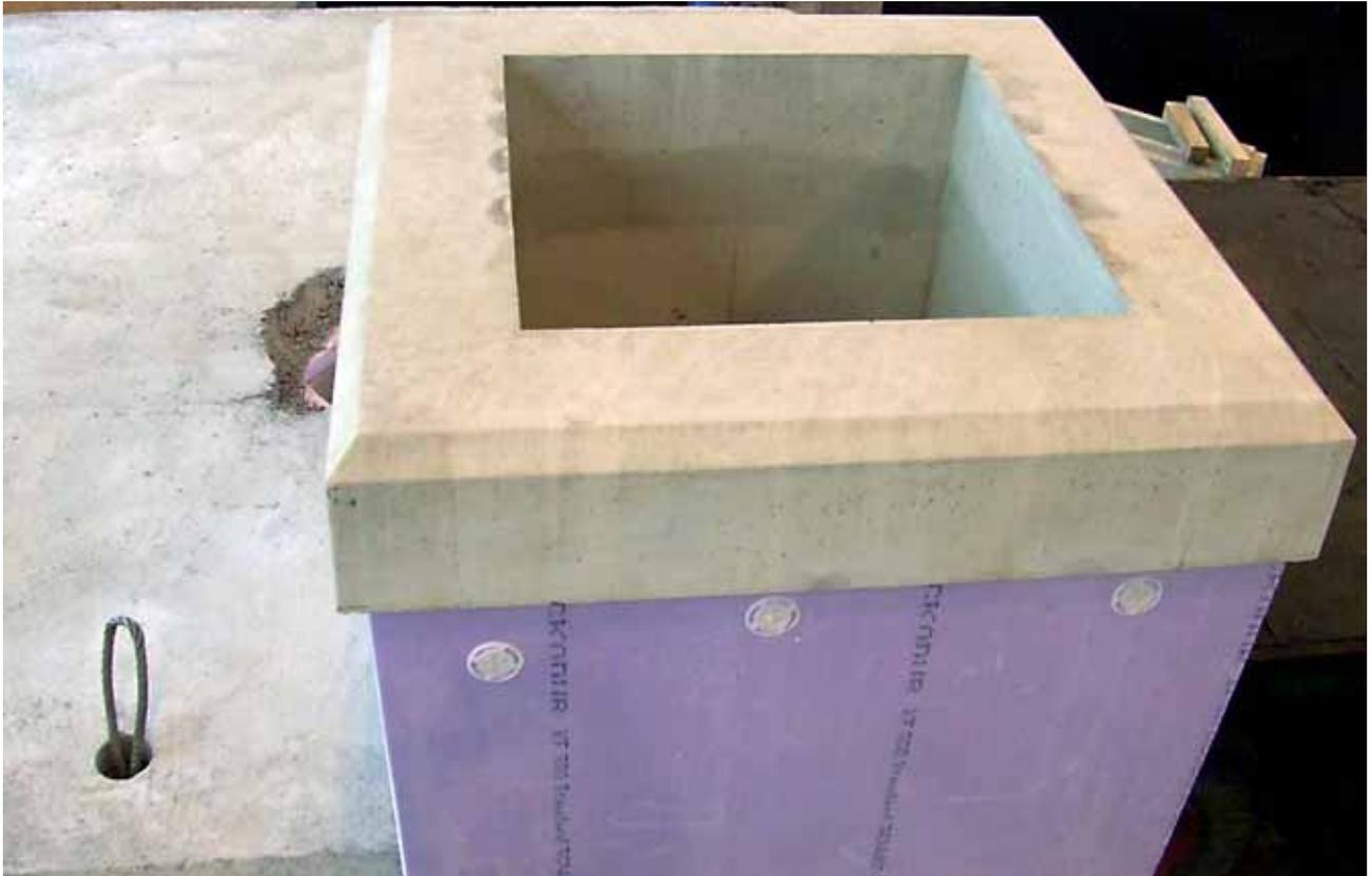
Deckenplatte mit Schachthals und Schachtvierung,
