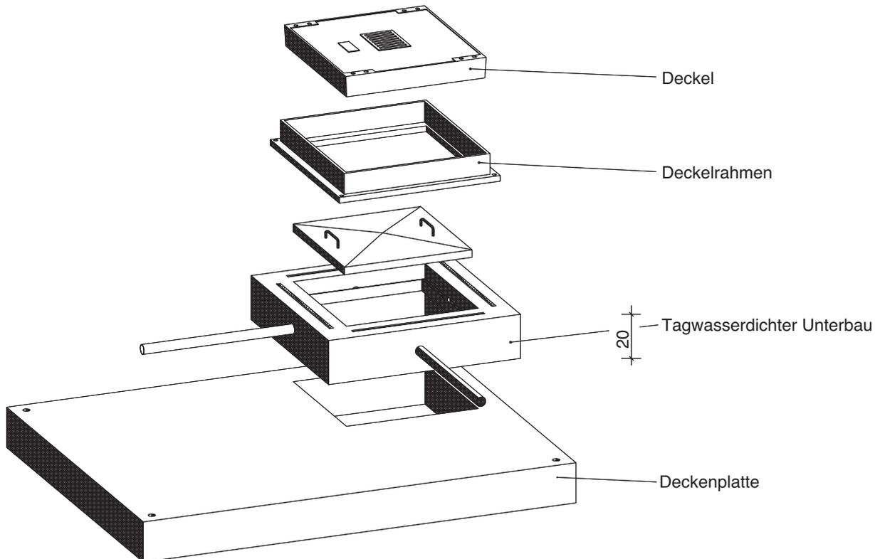
Der tagwasserdichte Unterbau stellt einen dauerhaften, sicheren und flexiblen Schutz gegen Eindringen von Oberflächenwasser oder Flüssigkeiten dar.
